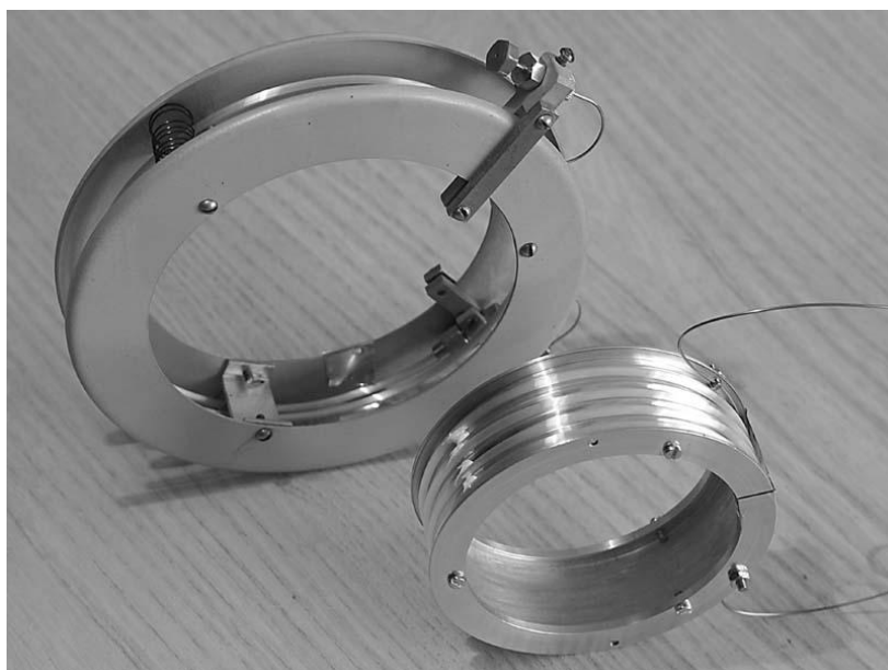
Рис.1 Фотография обычной и компактной (на переднем плане) спиральных поликапиллярных колонок в кассетах.
